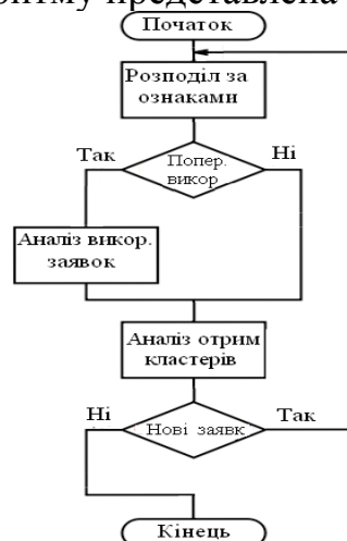
Рисунок 1 - Схема модифікованого алгоритму обробки вхідних заявок call-центром, що базується на алгоритмі кластеризації k-means
